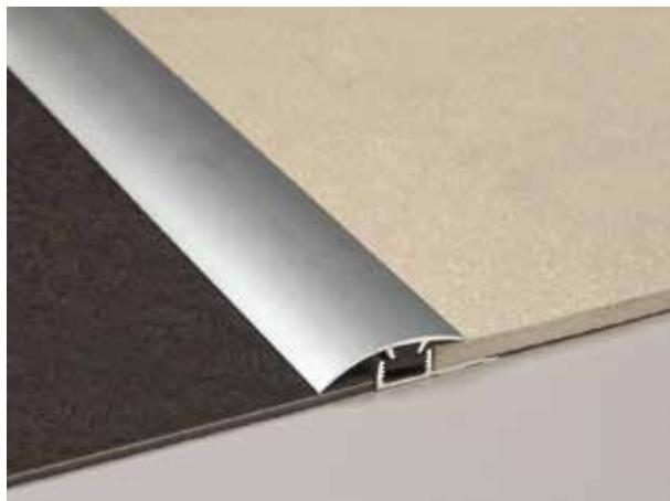
Profilo terminale brevettato per raccordare dislivelli tra 0÷6 mm per pavimenti LVT/SPC. Gli elementi che compongono il sistema MULTICLIP si combinano perfettamente tra loro grazie alla clip in materiale plastico, fornendo al sistema resistenza, registrabilità e flessibilità. La leggera rotazione del profilo di finitura permette al profilo di conformarsi perfettamente al dislivello da raccordare.
